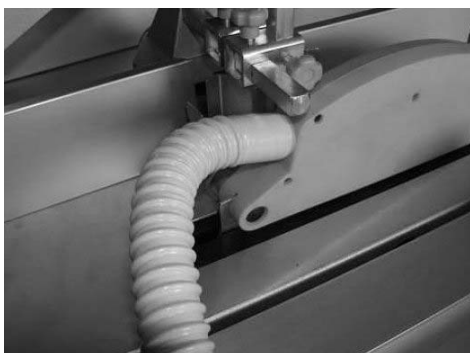
Obr. 20: Montáž odsávací hadice
