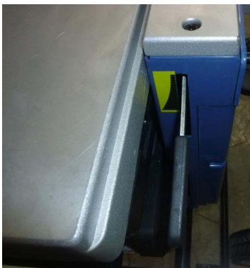
Obr. 31: Nastavení výšky stolu
