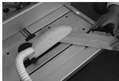
Obr. 23: Úhlový řez pomocí úhlového dorazu
