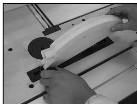
Obr. 18: Montáž ochranného krytu pilového kotouče
