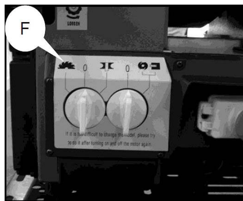
Obr. 16: Nastavení funkce pily
