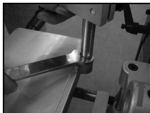
Obr. 12: Montáž upínacího zařízení obrobku
