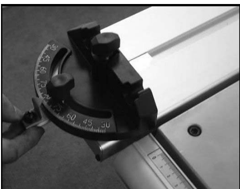
Obr. 9: Montáž úhlového dorazu
